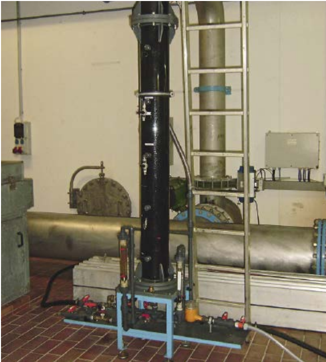
Abb. 5: Versuchsbetrieb des Kleinadsorbers KA (Filtersäule mit d_{innen} = 190\text{ mm} )
