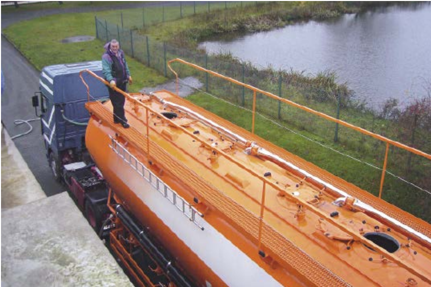
Abb. 4: Hydraulischer Füllvorgang von Filterzelle 5 (rechts) mit Aktivkohle mittels Silofahrzeug (links)
